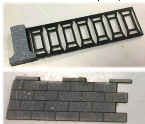
Для создания декоративных элементов использовался 3D принтер
